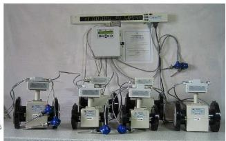
Ультразвуковые приборы учета - измерение расхода теплоносителя в таких приборах учёта происходит за счёт прохождения ультразвукового сигнала в направлении движения потока и противоположном ему. Разность времени такого прохождения как раз и позволяет фиксировать объем проходящего теплоносителя. Ультразвуковые приборы могут быть как с накладными, так и с врезными
