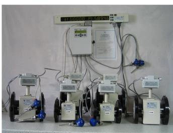
**Ультразвуковые приборы учета** - измерение расхода теплоносителя в таких приборах учёта происходит за счёт прохождения ультразвукового сигнала в направлении движения потока и противоположном ему. Разность времени такого прохождения как раз и позволяет фиксировать объем проходящего теплоносителя.
