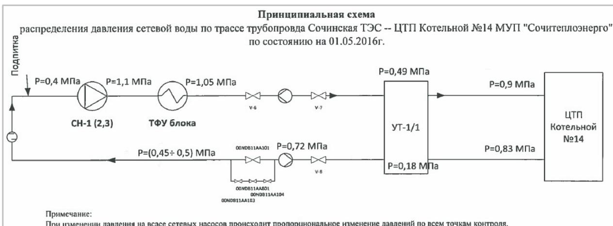
Рисунок 11. Принципиальная схема распределения давления в трубопроводе
