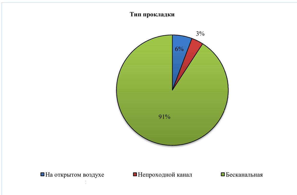
Рисунок 7. Типы прокладки тепловых сетей
