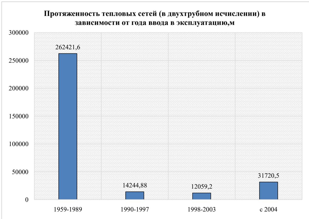
**Рисунок 10. Протяженность сетей в зависимости от года ввода в эксплуатацию**
