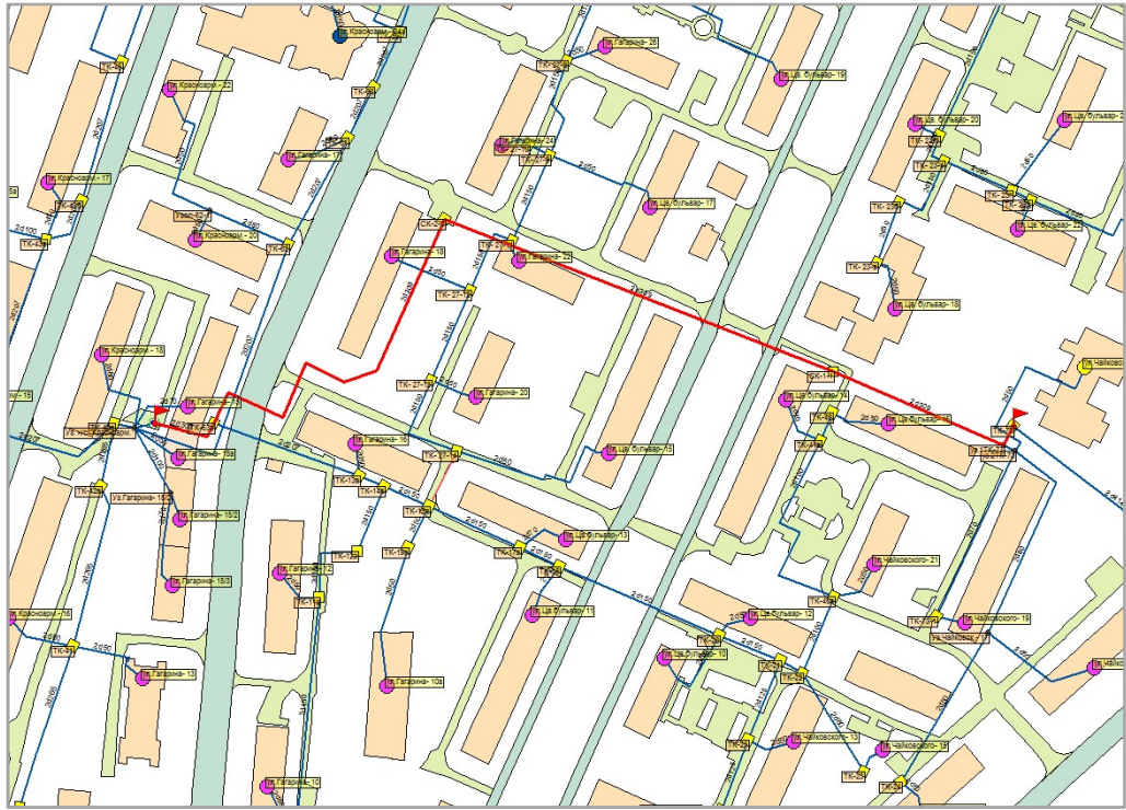
Рисунок 12. Перекладка участка тепловой сети котельной №3 от ТК-73 до НС "Красноармейская"
